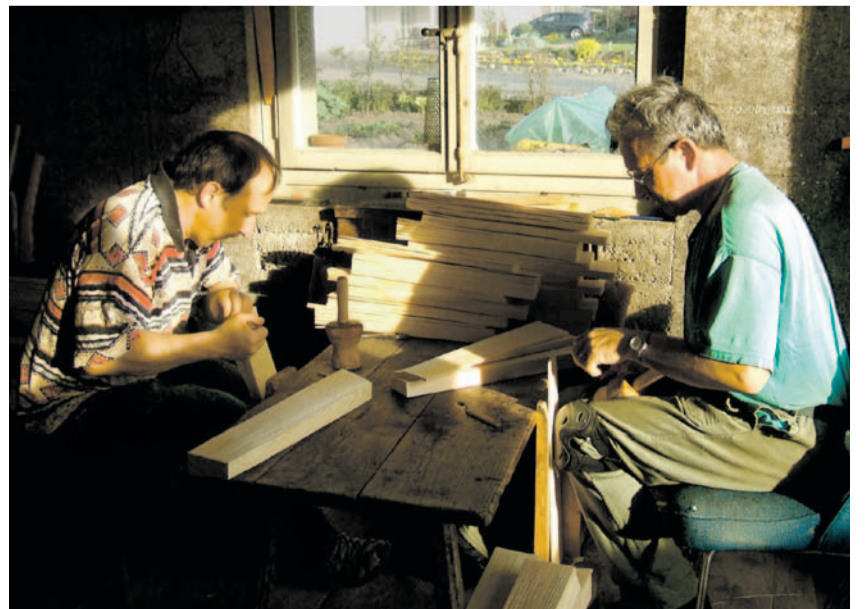
Die Gebrüder Hans und Fritz Muralt aus Ranflüh bei der Schindelproduktion für das Pfrundscheunedach in Rüdelswil.
